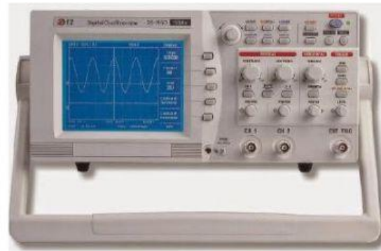
Gambar 6. Osiloskop menampilkan sinyal berupa grafik fungsi trigonometri
