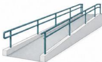
RAMPA De 0^{\circ} a 11^{\circ}
