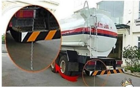
Hình 2.1. Dây xích nối đất trên xe chở xăng dầu (minh họa nhiễm điện do cọ sát)
