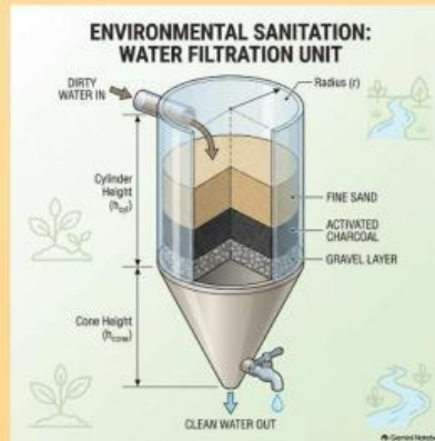
Gambar 44. Desain Unit Filtrasi Air Bersih Gabungan Tabung dan Kerucut (Sumber: Studio Gemini Notebook Graphics)
