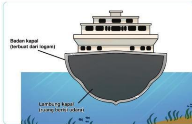
Gambar 4. Struktur kapal laut. (Sumber: buku IPA SMP/MTs Kelas IX, Gambar 3.4)
