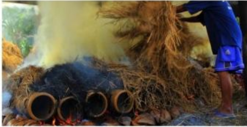
Gambar 4. Proses Pembakaran dengan jerami Sumber: gramedia.com
