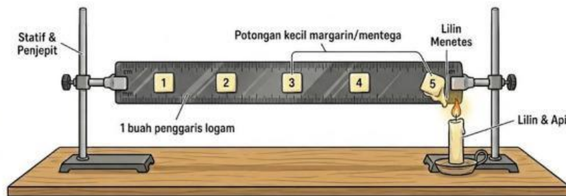
Gambar 7. Skema percobaan konduksi
