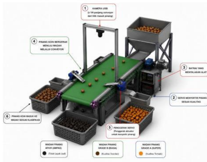
Gambar 1 Rancangan Sistem Konveyor Pinang (Sumber: ChatGPT)
