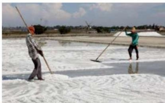
Gambar 4.5. Metode pemisahan evaporasi dan kristalisasi untuk memperoleh garam dari air laut.
