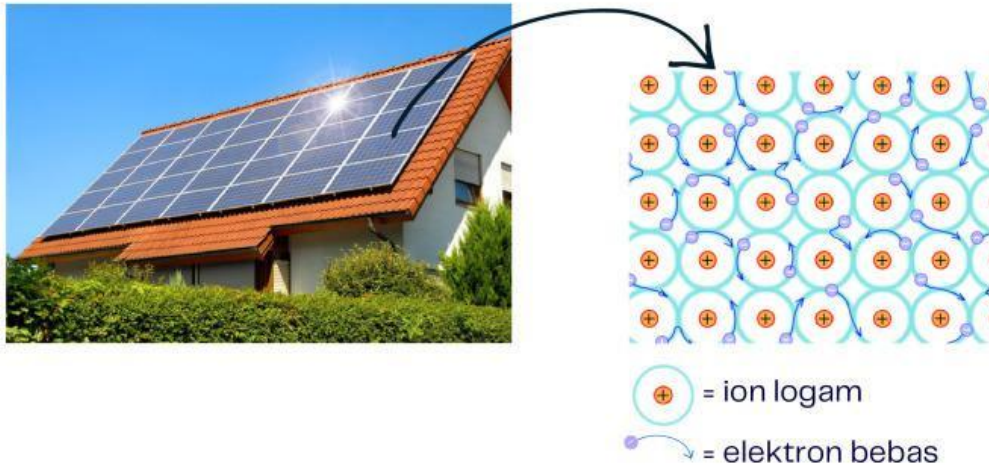
Gambar 11. Penggunaan logam sebagai penghantar listrik pada panel surya Sumber: https://share.google/uOFbGjjTCBUw6PYQ
