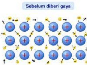
Gambar 13. Susunan Partikel Logam Saat Ditempa (Ponidi, 2020)
