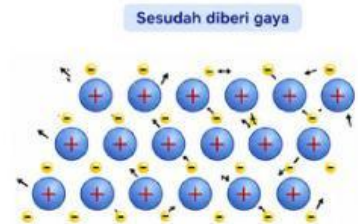
Gambar 13. Susunan Partikel Logam Saat Ditempa (Ponidi, 2020)
