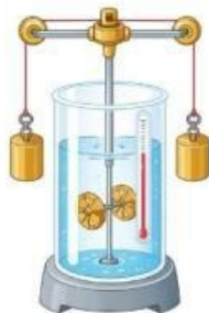
Gambar 2. Skema alat percobaan Joule Sumber: https://djukarna.wordpress.com/
