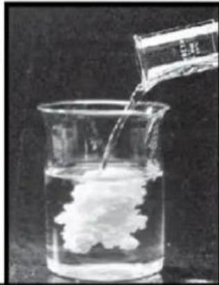
Serbuk Timbal (II) sulfat direaksikan dengan larutan Natrium Iodida
