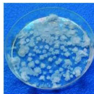
Cristales de sal común obtenidos mediante evaporación.
