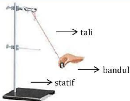
Gambar 2. Percobaan getaran dengan menggunakan bandul
