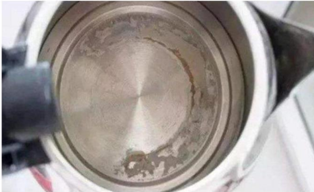
(Gambar Terbentuknya endapan pada pemanas air / kettle)
