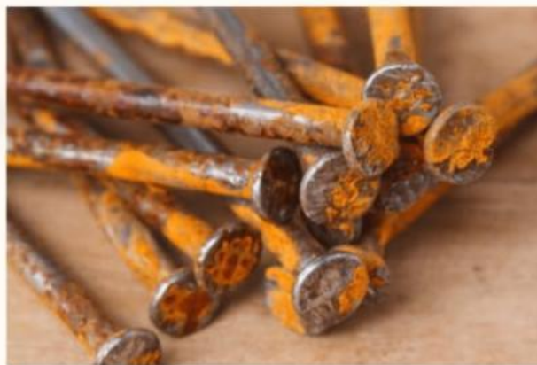
Gambar 1. Contoh korosi pada paku (Sumber: Kompas.com)
