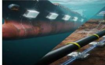
Gambar: Contoh penerapan perlindungan katodik pada lambung kapal menggunakan anoda korban
