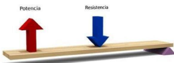
EL PUNTO DE APOYO ESTÁ EN UN EXTREMO, PERO LA FUERZA SE APlica ENTRE EL PUNTO DE APOYO Y LA RESISTENCIA (COMO EN UNAS PINZAS).
