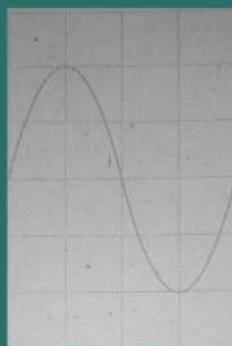
Tombol skala vertikal diatur pada 2 volt/cm dan tombol horizontal pada 5 ms/cm.
