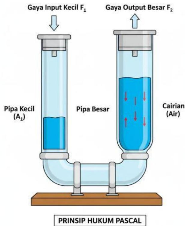
Gambar di atas menunjukkan skema alat percobaan yang akan kalian gunakan. Perhatikan dua pipa yang terhubung, satu pipa memiliki diameter kecil dan yang lainnya memiliki diameter besar. Ketika piston pada pipa kecil ditekan, tekanan akan diteruskan melalui air ke piston pada pipa besar, mendorongnya ke atas.
