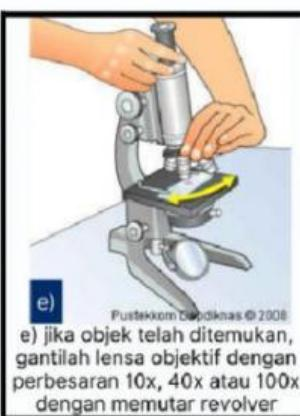
e) jika objek telah ditemukan, gantilah lensa objektif dengan perbesaran 10x, 40x atau 100x dengan memutar revolver
