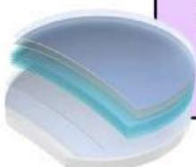
Lapisan tipis pada permukaan lensa atau layar dapat dirancang untuk menghasilkan interferensi destruktif pada cahaya tertentu, sehingga mengurangi refleksi dan meningkatkan transmisi cahaya.
