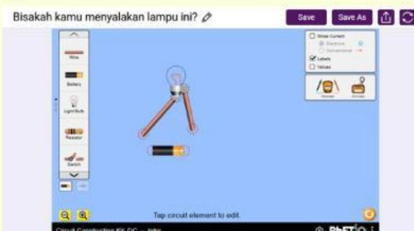
3. Hubungkan ujung-ujung kabel tersebut ke kutub baterai dengan cara menarik ujung kabelnya.
