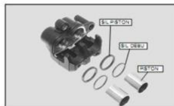
Gambar 5. 11 Perakitan Kaliper Rem
