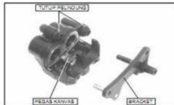
Gambar 5. 8 Pembongkaran Kaliper Rem
