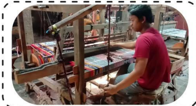
Gambar Proses Tenun Troso Jepara (Sumber : Dokumentasi Pribadi)
