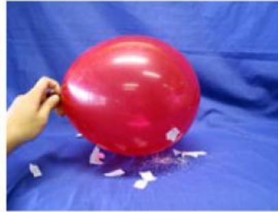
Gambar 1.2. Balon yang didekatkan ke kertas setelah digosokkan ke kain wol sumber : physicmax
