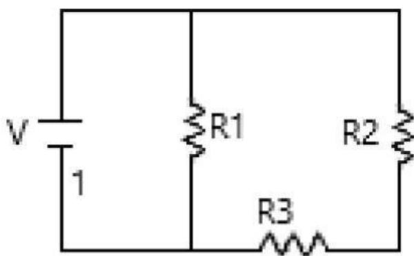
Las preguntas 4 a 8 están relacionadas con este circuito resistivo. Donde  $R_1=45.0\text{ k}\Omega$ ,  $R_2=180\text{ k}\Omega$ ,  $R_3=90.0\text{ k}\Omega$  y la alimentación = 9.00 V
