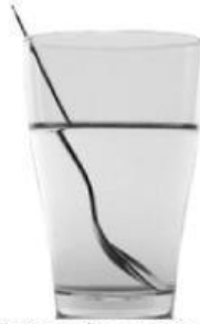
Gambar 4. Set Percobaan Pembiasan Cahaya Sumber:: Belajarmandiriyuk.com
