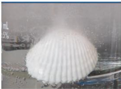
Gambar 2. Reaksi bongkahan cangkang kerang dengan larutan HCl.
