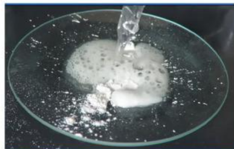
Gambar 3. Reaksi serbuk cangkang kerang dengan larutan HCl.
