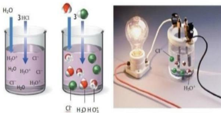
Gambar 21. Ionisasi larutan HCl dan daya hantar listrik larutan HCl (Sumber: Nivaldo, 2011)
