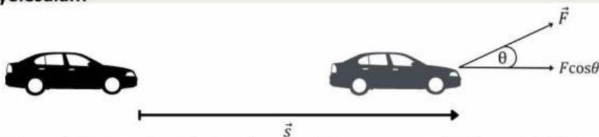
Sebuah mobil mengalami kerusakan mesin yang menyebabkan mobil tersebut mogok. Jika mobil ditarik 18 meter dengan arah gaya seperti pada gambar sebesar 210 N dengan sudut  $30^\circ$ . Hitung besarnya usaha yang digunakan untuk menarik mobil tersebut!
