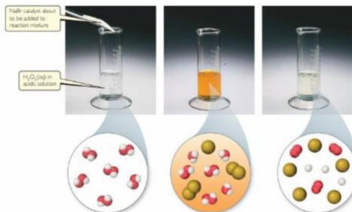
Gambar: Submikroskopik reaksi penguraian \text{H}_2\text{O}_2 dengan katalis NaBr
