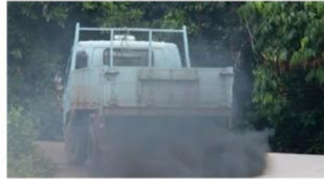
b) Mobil berjalan mengeluarkan asap berwarna hitam
