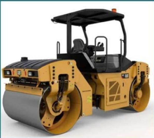
Tandem roller adalah alat berat yang digunakan untuk memadatkan tanah atau material, seperti aspal hotmix, agar menjadi padat dan halus. Tandem roller memiliki dua roda baja yang berjajar, satu di depan dan satu di belakang. Tandem roller biasanya digunakan pada saat pengaspalan jalan dengan sistem kerja sekali jalan.
