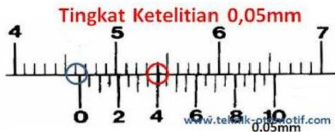
Gambar 11. Skala metris tingkat ketelitian 0,05 mm
