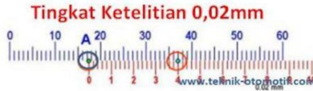
Gambar 12. Skala metris tingkat ketelitian 0,02 mm
