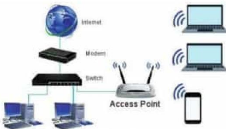
Hình 3. Các máy tính kết nối với Access Point thông qua sóng điện từ
