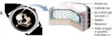
Kedua sel ini menyerupai baterai berbentuk kancing. Sel merkuri digunakan dalam kalkulator Berbagai jenis perangkat, seperti jam tangan, kamera, alat pacu jantung, dan alat bantu dengar menggunakan baterai berwarna perak. karena kinerjanya yang sangat stabil. Kerugian utama adalah toksisitas kebocoran merkuri dan tingginya biaya baterai perak.
