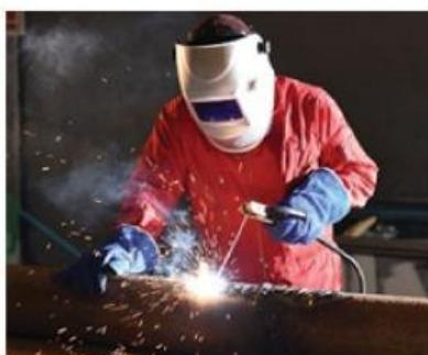
Tahukah anda kegiatan apa disamping ? Yup kegiatan mengelas atau memotong logam/besi. Bahan bakar yang digunakan dalam pengelasan bernama gas asetilen ( $C_2H_2$ ). Gas asetilen adalah gas sintesis yang diproduksi dari reaksi Kalsium Karbida dengan air yang disimpan dalam silinder yang berisi aseton.
