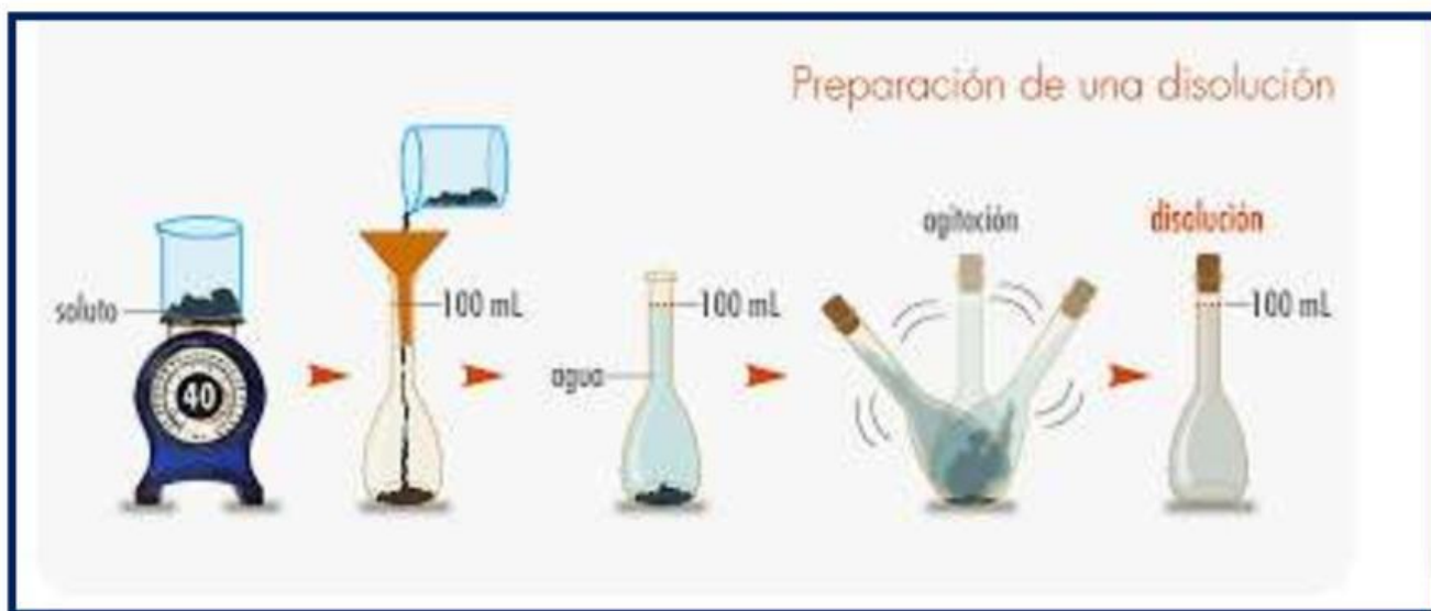
Imagen 1. Proceso de preparación de una disolución
