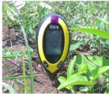
Gambar mengukur pH tanah menggunakan pH meter
