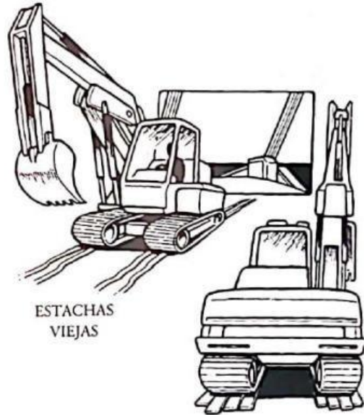
Fig. 11-137. Las unidades pesadas una vez en posición se colocan sobre madera de estiba y se trincan.
