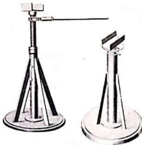
Fig. 1.199 Equipo para trincar trailers: calzos, cadenas y soportes.
