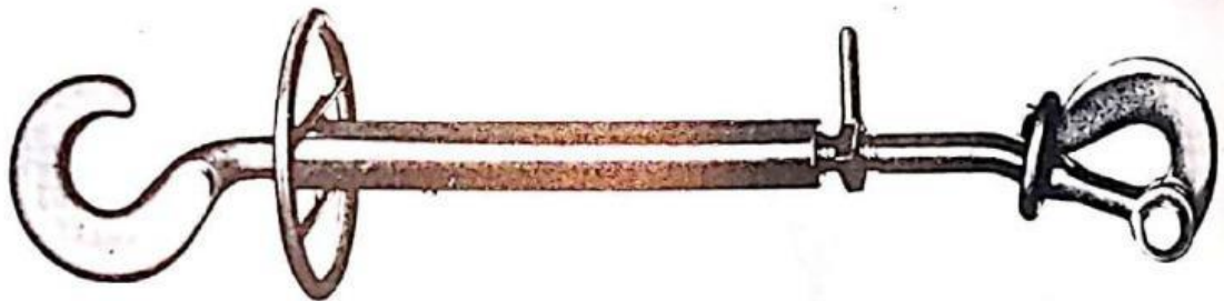
Fig. 1.196 Tensor para barra y cable.
