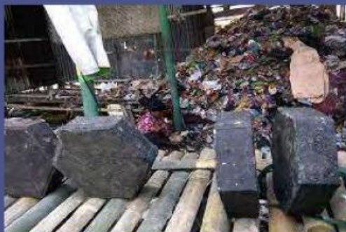
Gambar 22. Paving blok dari sampah plastik
