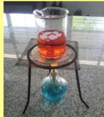
Gambar 2.51 Rangkaian Alat Simulasi Konveksi Mantel Bumi
