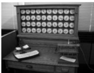
La máquina tabuladora de Hollerith (1890)
