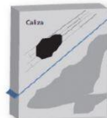
Cuña por cambio de porosidad - permeabilidad
