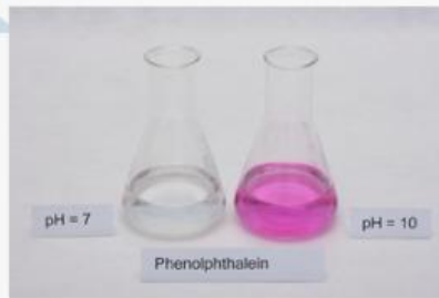
Gambar 6. Titrasi dengan Indikator Phenolftalein
