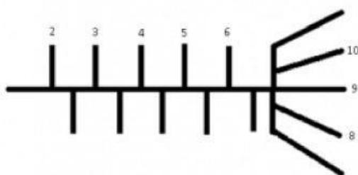
Gambar di atas adalah contoh hasil pengukuran menggunakan micrometer sekrup, Skala utama = 6,5 mm Skala nonius =  $(9 \times 0,01)$  mm = 0,09 mm Hasil pengukuran = 6,59 mm.
