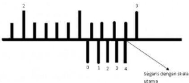
Gambar diatas adalah contoh hasil pengukuran dengan jangka sorong, Skala utama = 2,5 cm Skala nonius =  $(4 \times 0,1)$  mm = 0,04 cm Hasil pengukuran = 2,54 cm Angka 4 nonius segaris dengan skala utama, jadi angka inilah yang dikalikan dg batas ketelitian, kemudian dijumlahkan hasilnya dg hasil skala utama.
