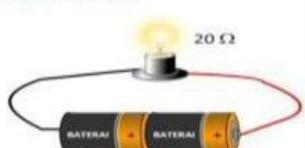
Dari gambar diatas bila tegangan masing-masing baterai adalah 1,5 volt dan lampu menyala selam 10 menit, energi listrik yang diubah menjadi cahaya oleh lampu tersebut adalah.
