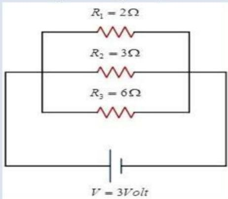
Rangkaian diatas memperlihatkan tegangan 3 volt dengan hambatan  $R_1$ ,  $R_2$  dan  $R_3$  berturut-turut besarnya adalah  $2\Omega$ ,  $3\Omega$  dan  $6\Omega$ . Tentukan berapakah besar arus total pada rangkaian listrik tersebut.
