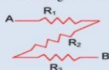
Rangkaian diatas memperlihatkan arus yang mengalir melalui titik A dan B jika R<sub>1</sub>, R<sub>2</sub> dan R<sub>3</sub> berturut-turut besarnya adalah 5 Ω, 10 Ω dan 15 Ω. Hambatan total dari rangkaian tersebut adalah.   Ω
