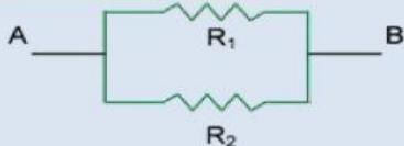
Pada rangkaian diatas jika  $R_1 = 9 \Omega$  dan hambatan pengganti antara titik AB adalah  $6 \Omega$ , maka tentukan besar hambatan pada  $R_2$ .
