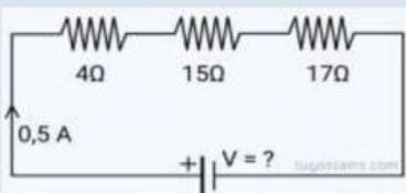
Rangkaian diatas memperlihatkan arus yang mengalir melalui hambatan  $R_1$ ,  $R_2$  dan  $R_3$  berturut-turut besarnya adalah  $4 \Omega$ ,  $15 \Omega$  dan  $17 \Omega$ . Tentukan berapakah tegangan listrik pada rangkaian listrik diatas..   V
