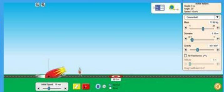
5. Klik tombol merah untuk melepaskan peluru dari meriam dan amati gerak peluru. Dengan menggunakan tombol menu "Time, Reigh and Height", klik dan geser menu tersebut dan letakkan pada titik tertinggi dan jarak terjauh pada lintasan, akan muncul data waktu saat bola melintasi titik tersebut, serta ketinggian dan jarak terjauh benda.
